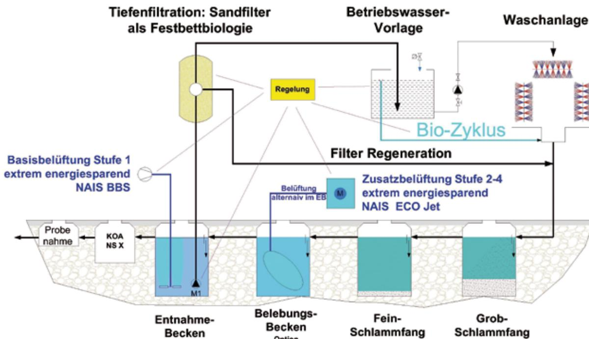
NAIS Anlagen arbeiten nach dem Vorbild der Natur. Die Vorklärung der Schmutzwässer erfolgt durch Schwerkraft (= Sedimentation).
