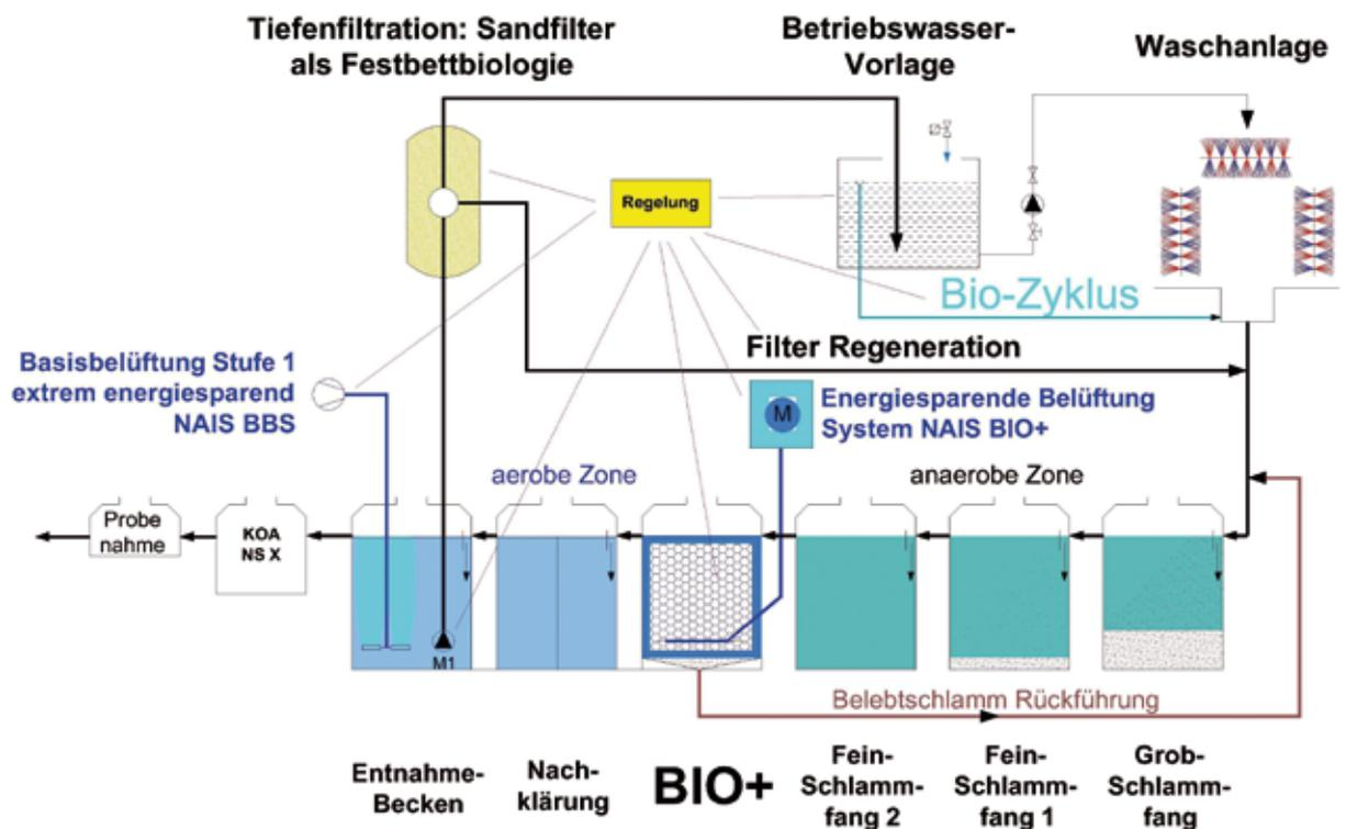
Im Grobschlammfang lagern sich alle Schmutzstoffe ab, die schwerer sind als Wasser (Sedimentation).
